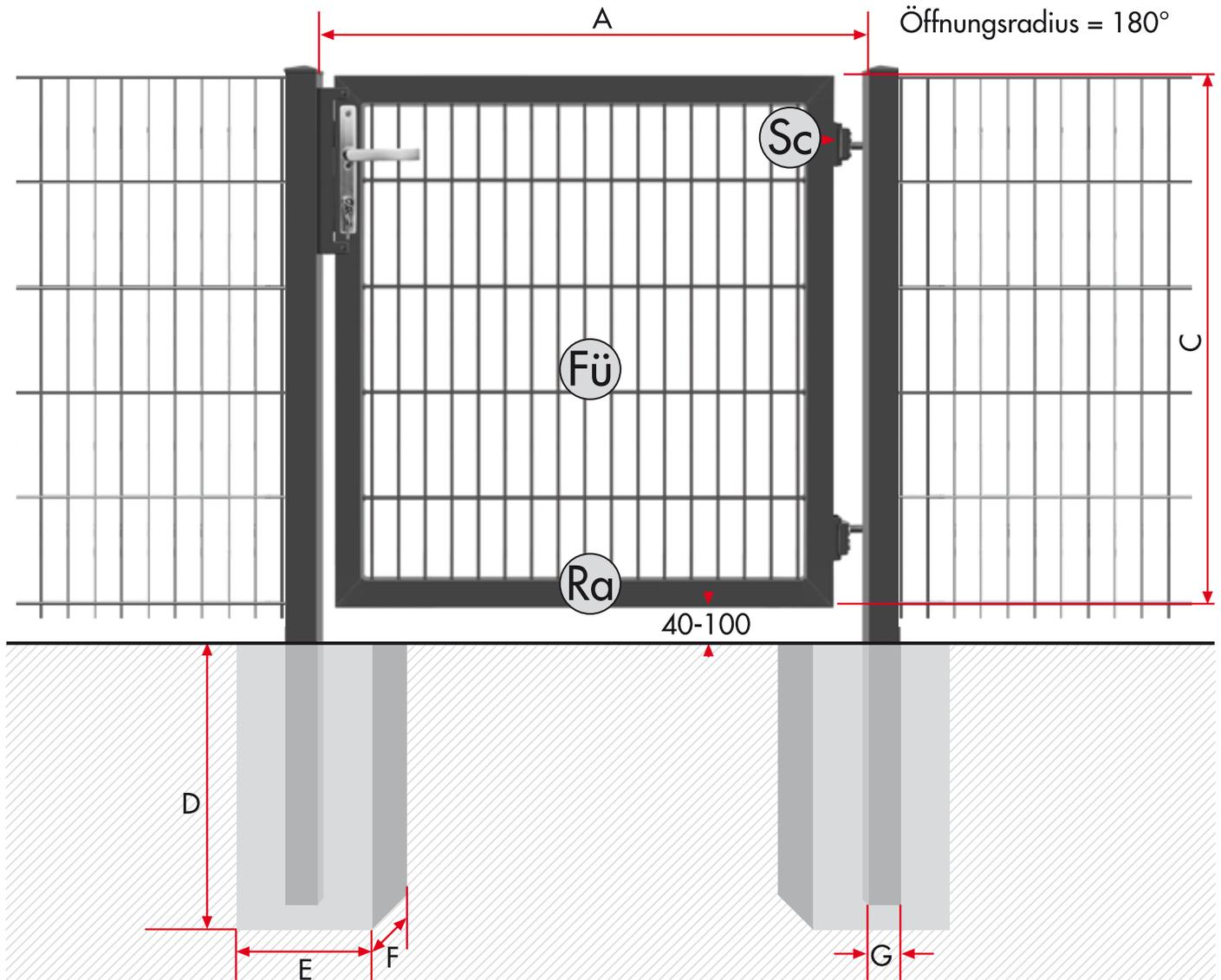
Rechts und links verwendbare Anschläge und Scharniere können bei Toren nur bis zu einer lichten Weite von 1,75 m und bei Quadratpfosten bis zu 80 x 80 mm verwendet werden.
