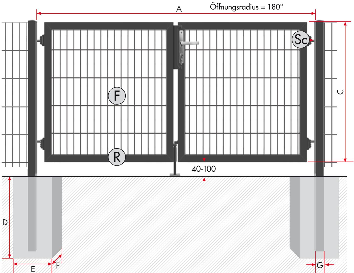
Rechts und links verwendbare Anschläge und Scharniere können bei Toren nur bis zu einer lichten Weite von 3,50 m und bei Quadratpfosten bis zu 80 x 80 mm verwendet werden.
